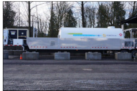
LNG Mobile Refueling Unit
